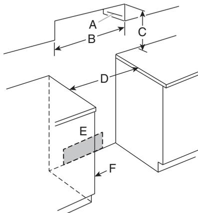
A. Profondeur maximum de l'armoire supérieure : 13 po (33,0 cm)
