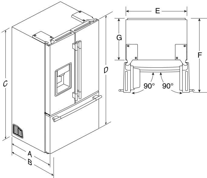
Le style de poignée et de porte variera selon le modèle. Les dimensions « C » et « D » incluent les roulettes sorties de 3/4 po (1,9 cm).
