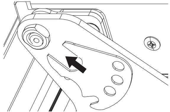
7. Tourner légèrement la bague pour aligner les trous de vis de la charnière et de la plaque de verrouillage.
