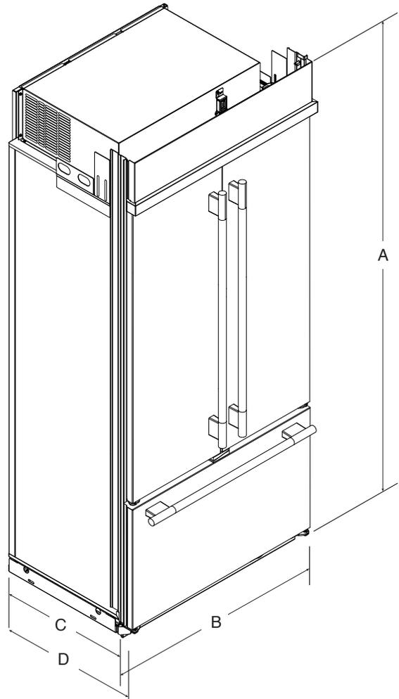
\*Lorsque les pieds de nivellement sont totalement déployés de  $1\frac{1}{4}$  po (31,8 mm) au-dessous des roulettes, ajouter  $1\frac{1}{8}$  po (28,6 mm) à la hauteur totale.
