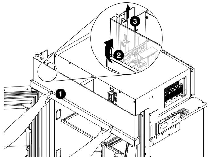
3. Retirer les deux garnitures latérales qui soutiennent la grille du réfrigérateur en dévissant les six vis hexagonales de 1/4 po. Conserver les vis et les garnitures pour les assembler avant d'installer l'appareil dans l'armoire.
