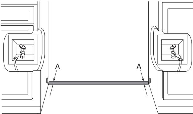
A. Le trou d'accès à la conduite d'eau doit être situé à moins de 1/2 po (13 mm) du mur arrière.
