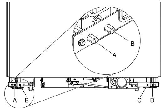
A. Vis de nivellement avant
