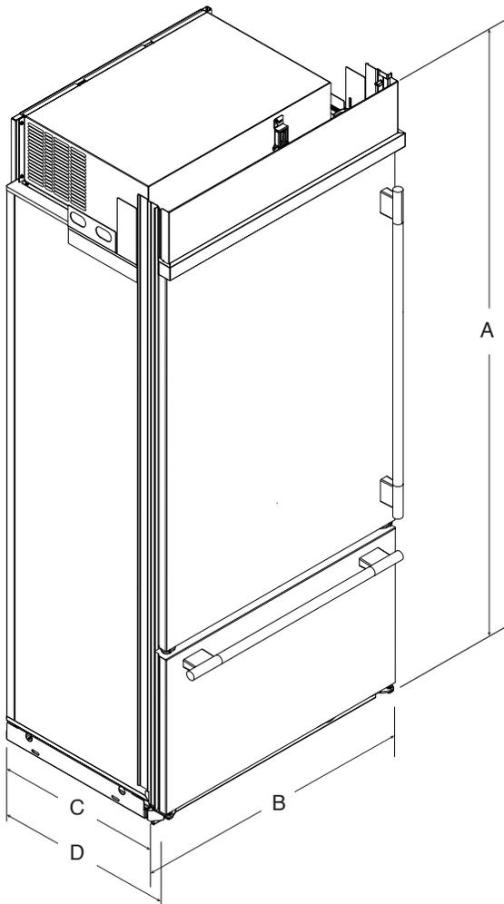
\*Lorsque les pieds de nivellement sont totalement déployés de  $1\frac{1}{4}$  po (31,8 mm) au-dessous des roulettes, ajouter  $1\frac{1}{8}$  po (28,6 mm) à la hauteur totale.
