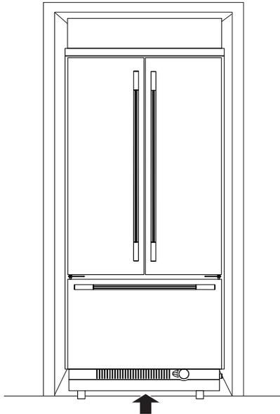
3. Vérifier visuellement que le cordon d'alimentation et la conduite d'eau ne sont pas coincés ou pincés.
