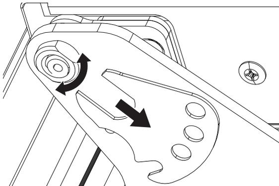
4. Faire tourner les bagues situées sous la charnière – utiliser une clé à fourche de 1/2 po. La rotation de la bague vers la gauche provoque un abaissement de la porte. La rotation de la bague vers la droite provoque un soulèvement de la porte. Voir l'illustration.
