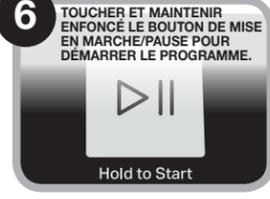
**REMARQUE :** Le bouton Start (Mise en marche) doit être maintenu enfoncé pendant 1 seconde pour démarrer le programme. Une fois que la ligne inférieure des témoins situés à gauche du bouton Start (Mise en marche) est allumée, relâchez le bouton Start (Mise en marche).
