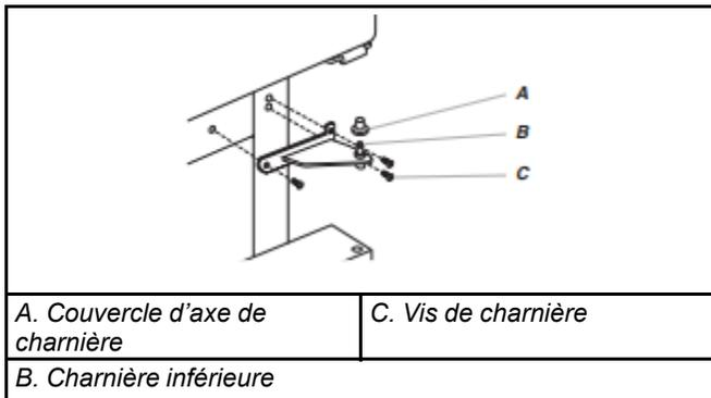
**REMARQUE :** Prévoir un support supplémentaire pour les portes du réfrigérateur pendant le déplacement des charnières. La force d'attraction des aimants de la porte ne suffit pas à les maintenir en place pendant la manutention.
