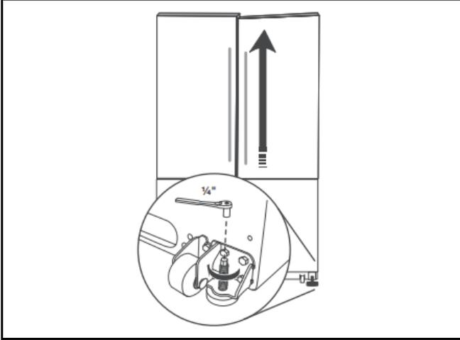
6. S'assurer que le réfrigérateur est stable. Si le réfrigérateur semble instable ou qu'il roule vers l'avant lorsqu'on ouvre la porte ou le tiroir, ajuster les vis de nivellement. À l'aide d'un tourne-écrou à tête hexagonale de 1/4 po, tourner les vis de nivellement dans le sens horaire de chaque côté jusqu'à ce que les pieds de nivellement soient en contact ferme avec le plancher.
